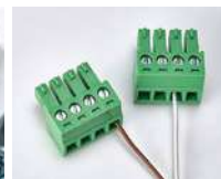
Фото 14. Подключение провода датчика к ответной части разъема
