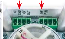
Фото 13. Клеммы подключения проводных датчиков — INP, GND
