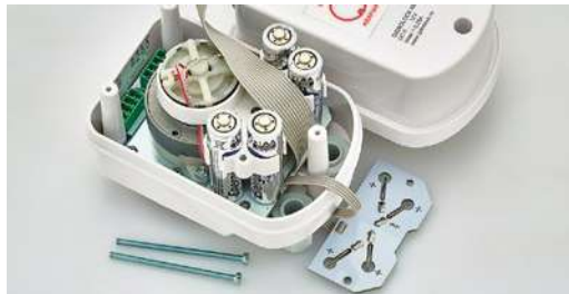
Фото 17. Контактная площадка снята, батарейки могут быть заменены
