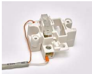
Фото 22. Подключение проводного выключателя
