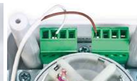
Фото 15. Подключение датчика к электроприводу
