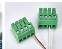
Фото 14. Подключение провода датчика к ответной части разъема
