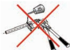
Трубу следует защищать от попадания на нее масел и не применять смазки при выполнении соединения с использованием подвижной гильзы
