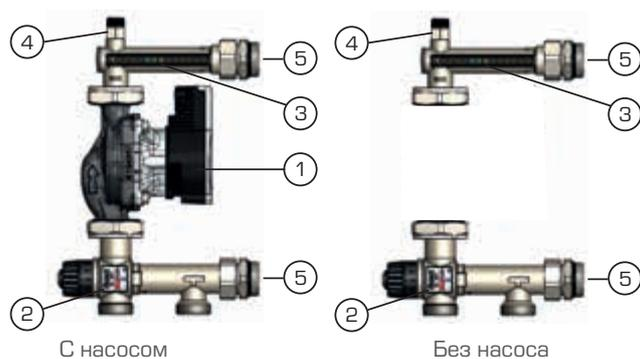
Рис. 7. Устройство смесительного насосного узла для «теплого пола»
