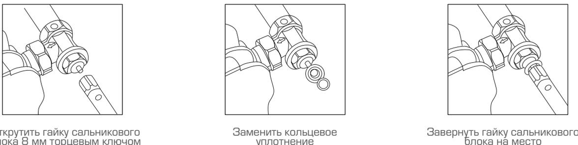
Открутить гайку сальникового блока 8 мм торцевым ключом
