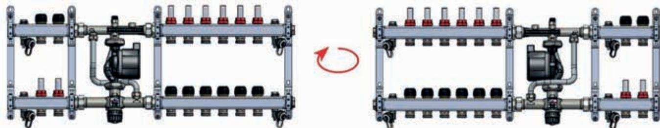
На заводе-изготовителе термостатический клапан насосно-смесительного узла настраивается на температуру 30°C при этом, температура теплоносителя может регулироваться и блокироваться поворотом рукоятки термостатического клапана в диапазоне 30-60°C;
