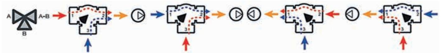
На рисунке проиллюстрированы все возможные способы использования клапанов для слияния потоков. Обратите внимание на расположение механической системы блокировки (цифра - 3) и пластины с градуированной шкалой, а также на нумерацию выходов.
