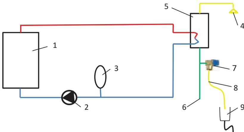
1 – котел; 2 – насос; 3 – расширительный бак; 4 – система ГВС; 5 – водонагреватель;
