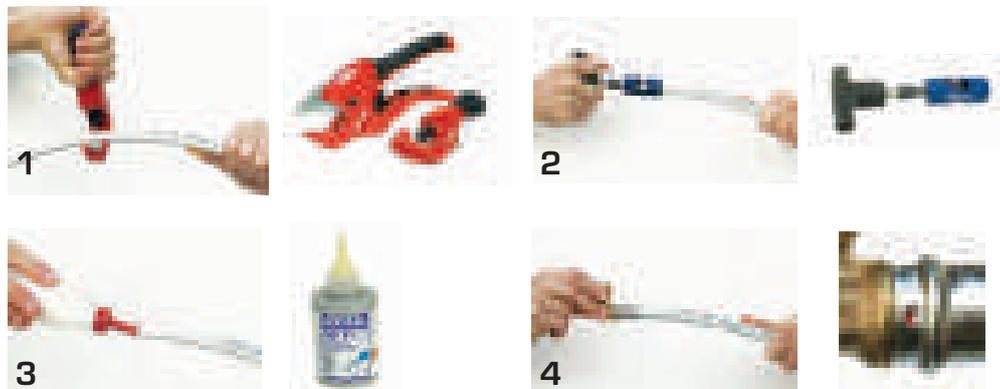
1. Обрезать трубу перпендикулярно ее оси специальным инструментом (ножницами или резакром).
