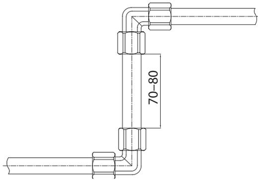
При прокладке трубопровода расстояние между соседними фитингами должно быть не менее 70 мм (для  $\varnothing$  32 – 80 мм).
