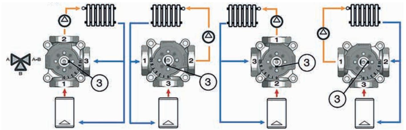
Клапан смесительный регулирующий 3-ходовой можно использовать не только для слияния потоков, но и в качестве разделителей. Помимо этого, клапаны можно применять для повышения температуры обратного потока в теплогенератор, чтобы предотвратить конденсацию (в твердотопливных или дизельных генераторах).
