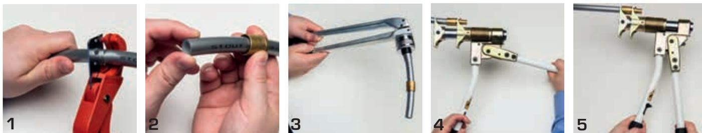
1. Отрежьте трубу перпендикулярно её оси с помощью подходящего трубореза. При резке следует соблюдать угол 90 ° и исключить образование заусенцев;
