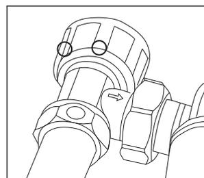
Рис. 19. Использование защитного колпачка для регулирования температуры
