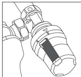
Рис. 18. Монтажное положение термоголовки и клапана терморегулятора
