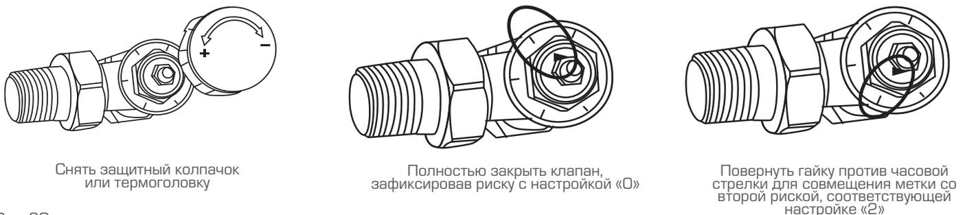
Снять защитный колпачок или термоголовку
