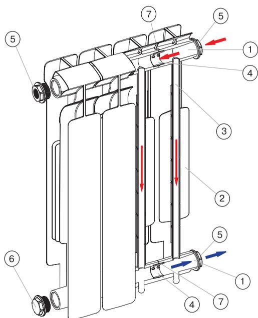
В коллекторах выполнена трубная цилиндрическая резьба G1" (с одной стороны правая, а с другой – левая), которая служит для соединения секций между собой в радиаторные батареи различной длины с помощью стальных резьбовых nipples (4), а также для установки проходных (5) и глухих (6) пробок на торцах коллекторов собранного радиатора. Геометрия межсекционных соединений и параметры материала прокладок (7) гарантируют повышенную герметичность собранного радиатора.
