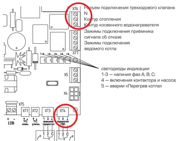
Рис. 13. Схема подключения датчика температуры бойлера
