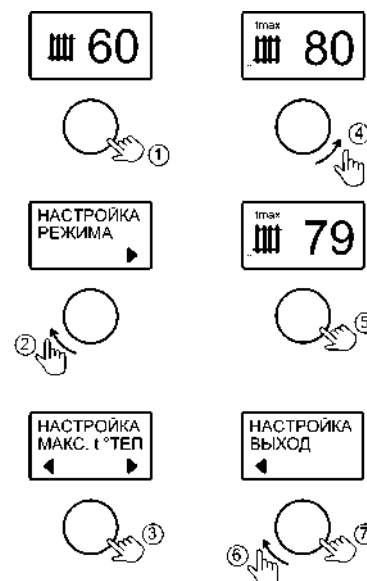
Рисунок 9. Настройка максимальной температуры теплоносителя
