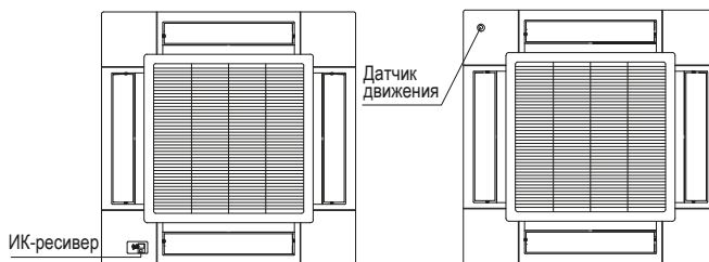
Приемник беспроводного пульта управления и датчика движения могут быть установлены, как показано на рисунке
