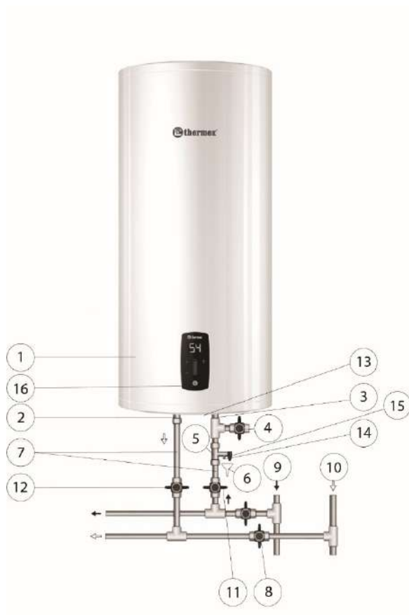
Рисунок 1. Схема подключения ЭВН к водопроводу
