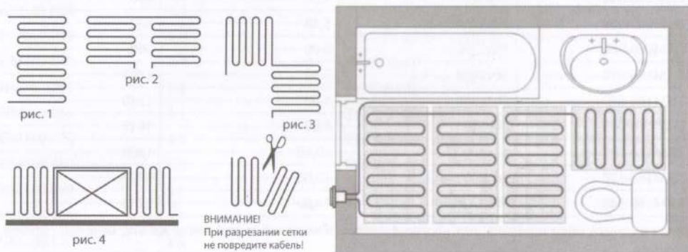
Возможные варианты укладки нагревательных матов
