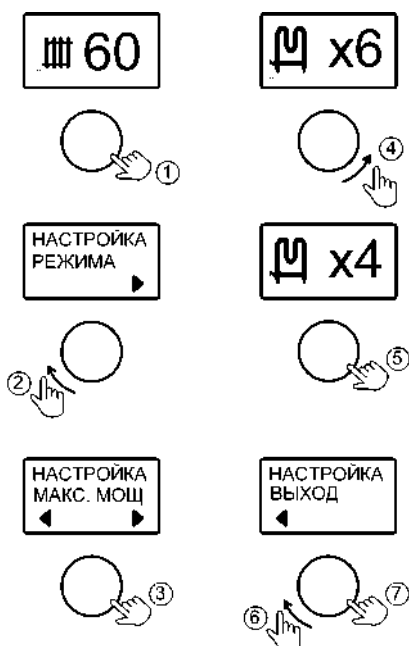
Рисунок 8. Настройка мощности котла
