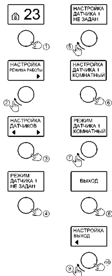
Рисунок 11. Настройка датчиков температуры воздуха
