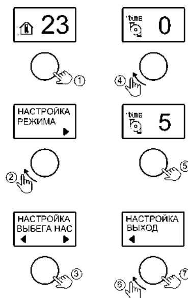
Рисунок 12. Настройка времени выбега насоса
