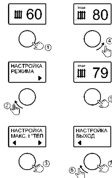
Рисунок 9. Настройка максимальной температуры теплоносителя
