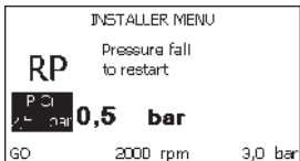
Рисунок 17: Настройка давления нового включения
