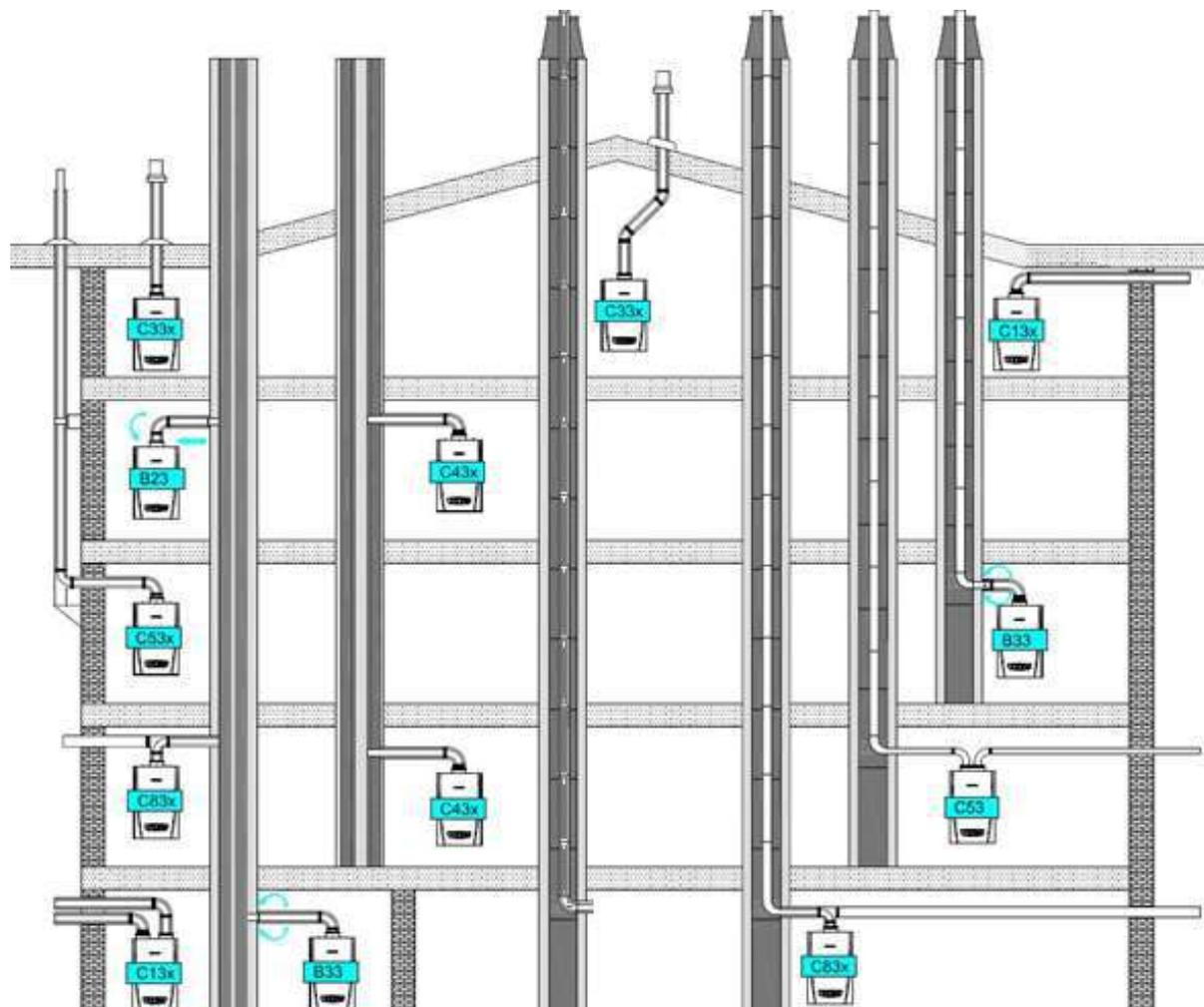
Котлы **PROTEUS Premix** оснащены вентилятором, который подаёт дымовые газы в дымоход. Из-за потерь давления в дымоходе происходит торможение дымовых газов. Поэтому длина дымовых труб  $L$  не должна превышать максимальной величины, чтобы обеспечить надёжный отвод дымовых газов в атмосферу.
