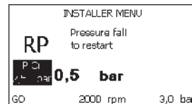
Рисунок 18: Настройка давления нового включения
