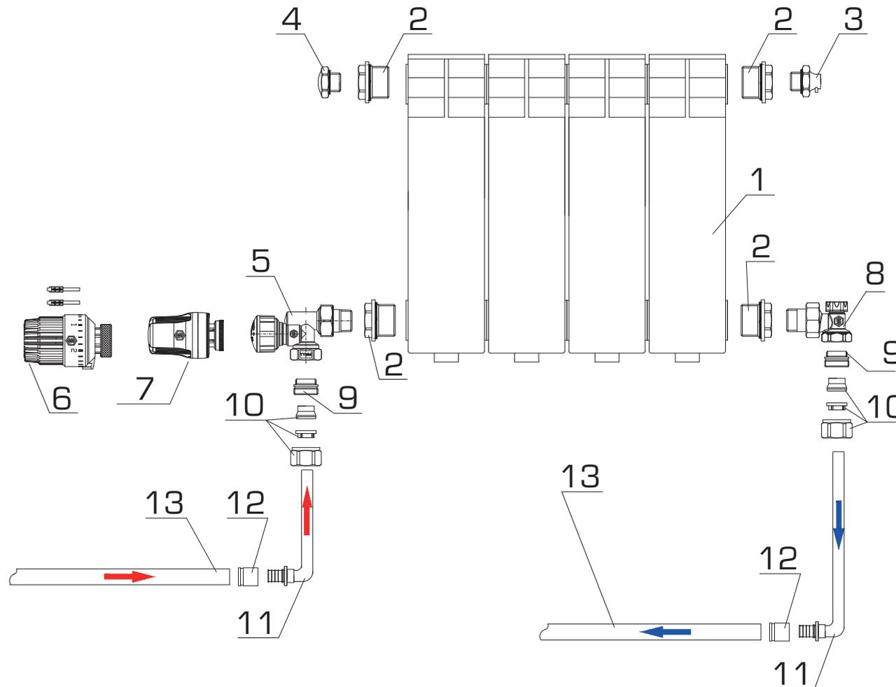
\* термостатическая головка должна находиться в горизонтальном положении относительно пола
