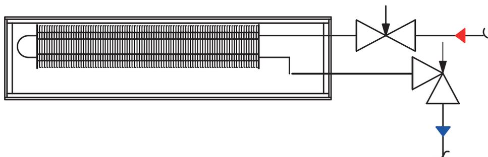
Обвязка внутривольного конвектора с запорно-балансировочными клапанами металлопластиковыми трубами PE-Xb/Al/PE-Xb и пресс-фитингами
