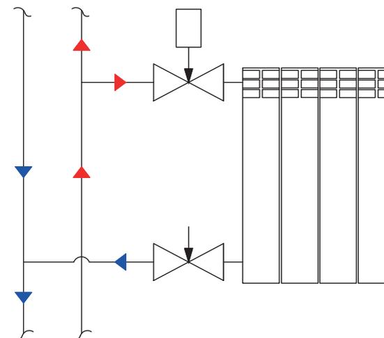
Обвязка радиатора с термостатическим клапаном (и головкой термостатической) металлополимерными трубами PE-Xb/Al/PE-Xb и винтовыми фитингами
