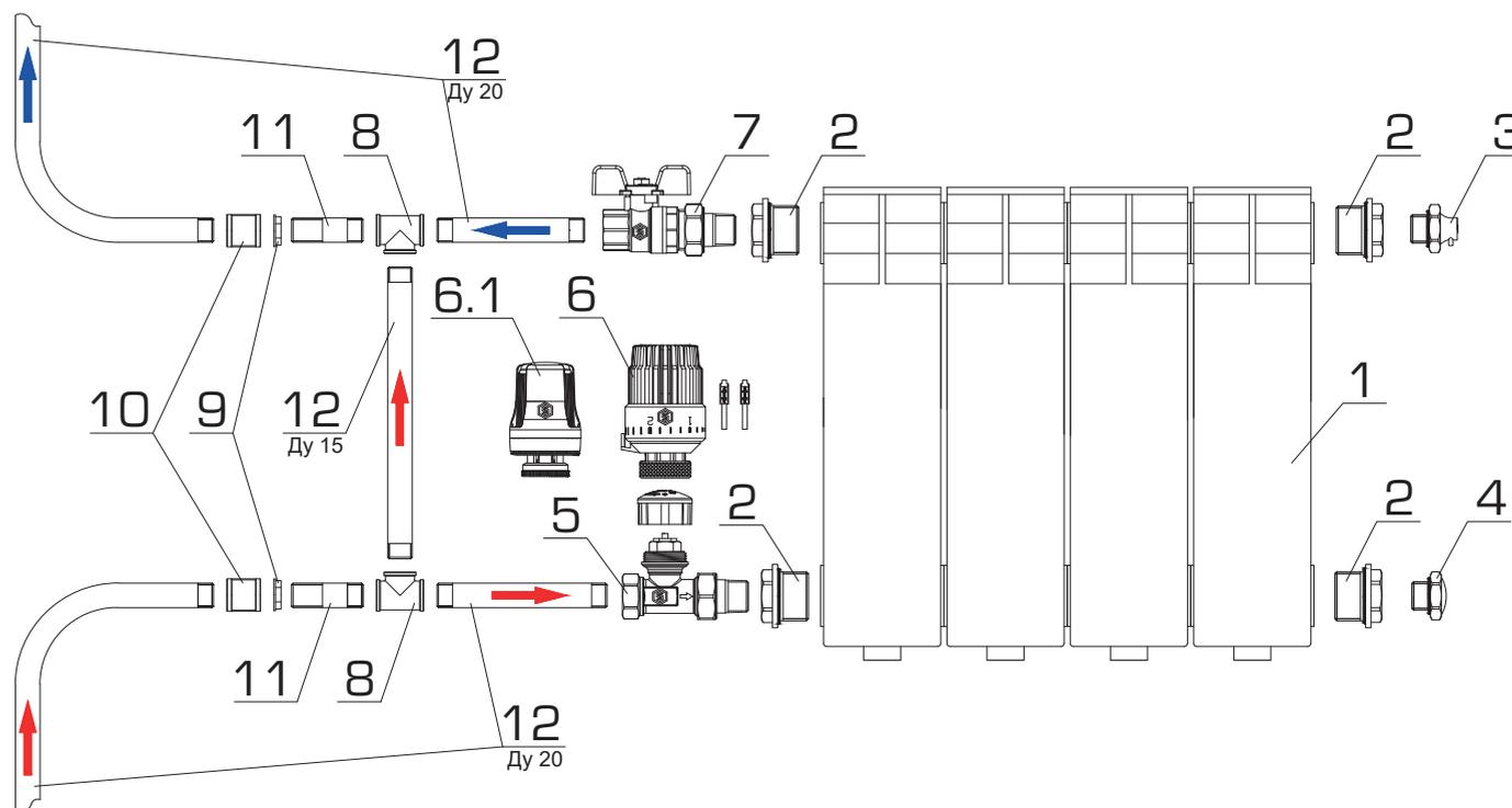
\* термостатическая головка должна находиться в горизонтальном положении относительно пола
