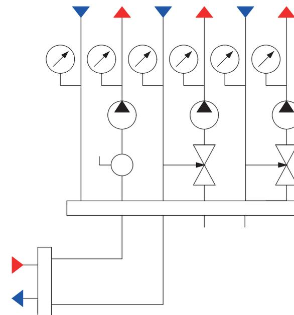
Гидро модули быстрого монтажа с вертикальным гидравлическим разделителем, коллектором распределительным универсальным и водогазопроводными трубами
