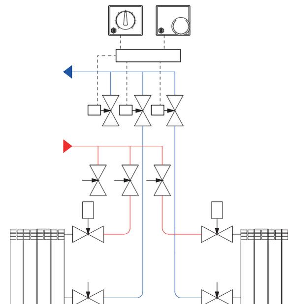
**Система радиаторной разводки с коллекторной группой SMS 0923 и PE-X трубами**
