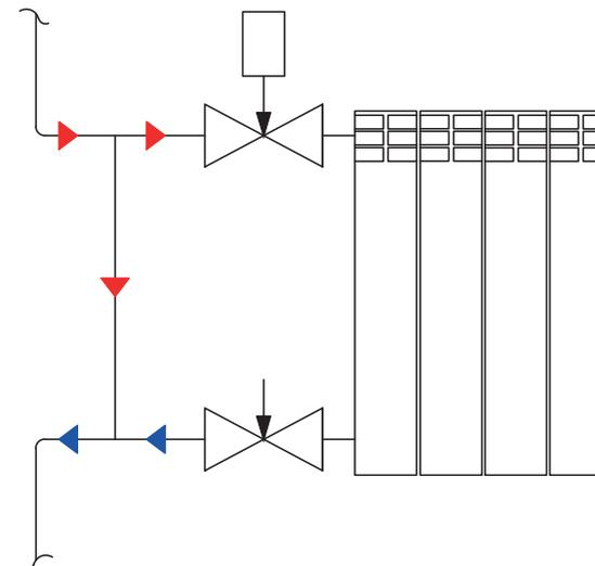
Обвязка радиатора с термостатическим клапаном (и головкой термостатической) стальными водогазопроводными трубами и резьбовыми фитингами
