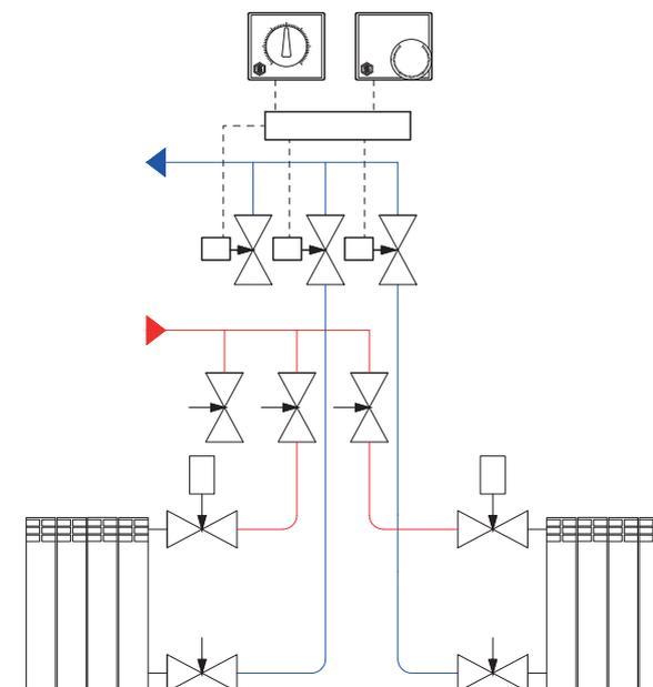
Система радиаторной разводки с коллекторной группой SMS 0922 и PE-X трубами
