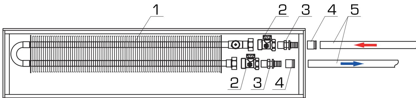
Обвязка внутривольного конвектора с запорно-балансировочными клапанами металлопластиковыми трубами PE-Xb/Al/PE-Xb и винтовыми фитингами
