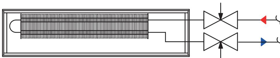
Обвязка внутривольного конвектора с запорно-балансировочными клапанами металлопластиковыми трубами PE-Xb/Al/PE-Xb и пресс-фитингами
