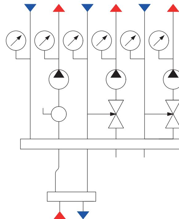
Гидро модули быстрого монтажа с горизонтальным гидравлическим разделителем, коллектором распределительным универсальным и водогазопроводными трубами
