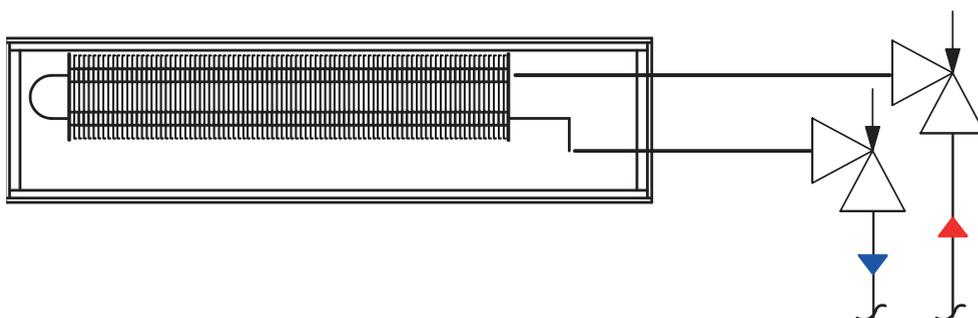
Обвязка внутривольного конвектора с запорно-балансирующими клапанами металлопластиковыми трубами PE-Xb/Al/PE-Xb и пресс-фитингами
