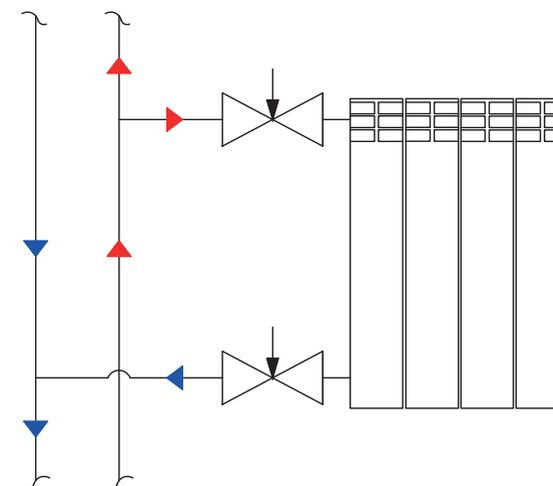
Обвязка радиатора с клапаном ручным регулировочным стальными водогазопроводными трубами и резьбовыми фитингами
