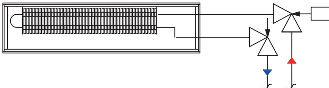
Обвязка внутривольного конвектора с запорно-балансировочными клапанами металлопластиковыми трубами PE-Xb/Al/PE-Xb и пресс-фитингами
