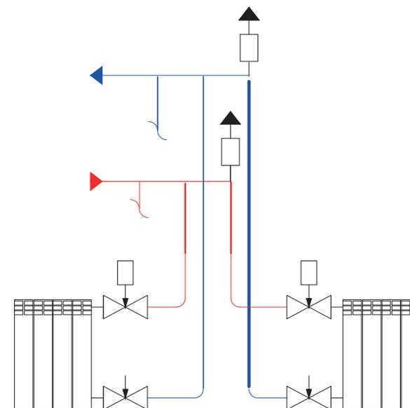
Система радиаторной разводки с коллекторной группой SMS 0923 и PE-X трубами
