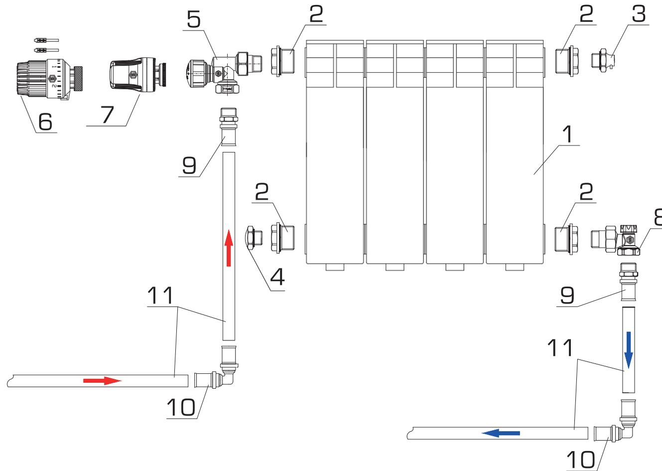
\* термостатическая головка должна находиться в горизонтальном положении относительно пола
