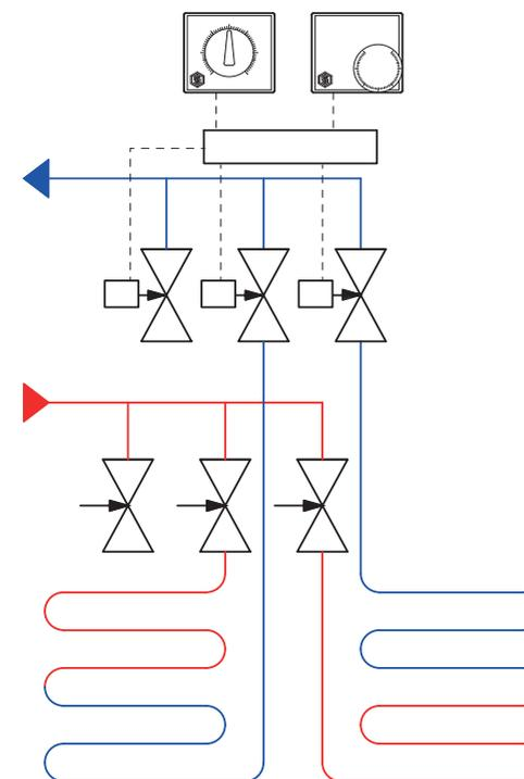
Система теплого пола с коллекторной группой SMS 0917 и PE-X трубами
