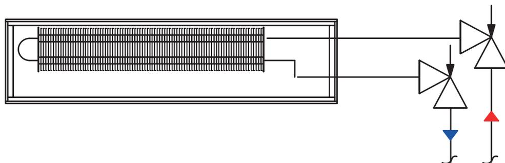
Обвязка внутриспольного конвектора с запорно-балансировочными клапанами металлопластиковыми трубами PE-Xb/Al/PE-Xb и винтовыми фитингами
