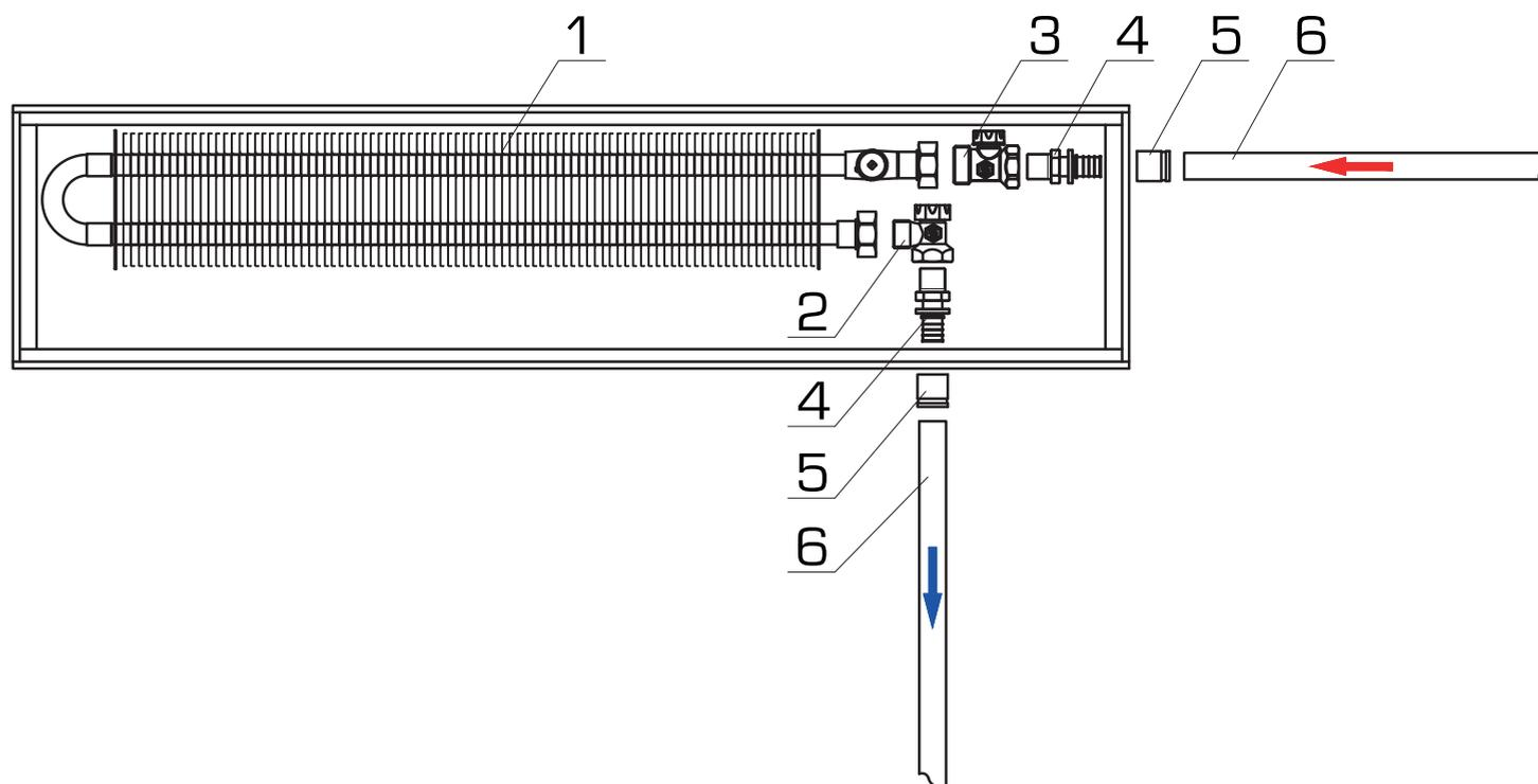
Обвязка внутривольного конвектора с запорно-балансировочными клапанами полиэтиленовыми трубами PE-Xa/ PE-Xc/ Al/PE-Xc и аксиальными фитингами
