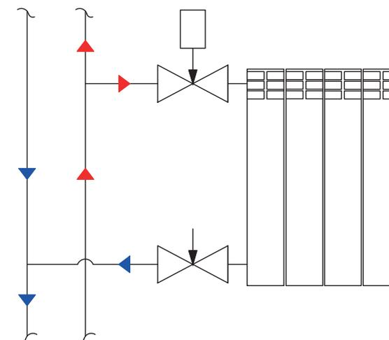
Обвязка радиатора с термостатическим клапаном (и головкой термостатической) стальными водогазопроводными трубами и резьбовыми фитингами
