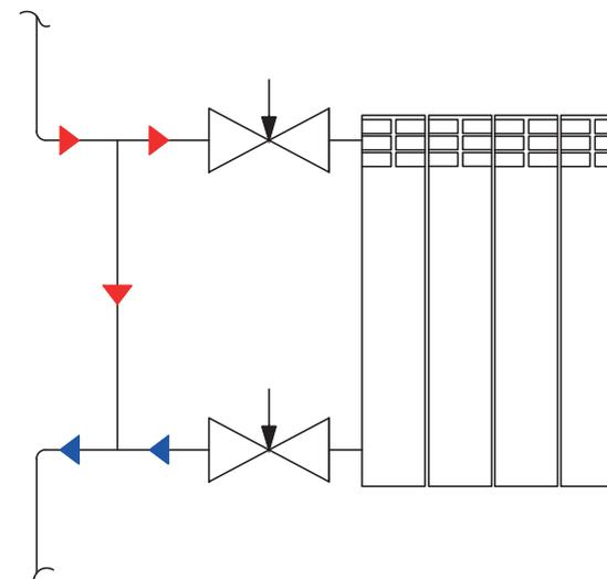
Обвязка радиатора с клапаном ручным регулировочным металлополимерными трубами PE-Xb/Al/PE-Xb и винтовыми фитингами
