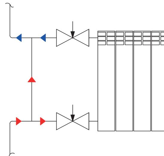
Обвязка радиатора с клапаном ручным регулировочным стальными водогазопроводными трубами и резьбовыми фитингами
