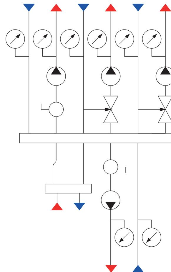
Гидро модули быстрого монтажа с горизонтальным гидравлическим разделителем, коллектором распределительным универсальным и водогазопроводными трубами
