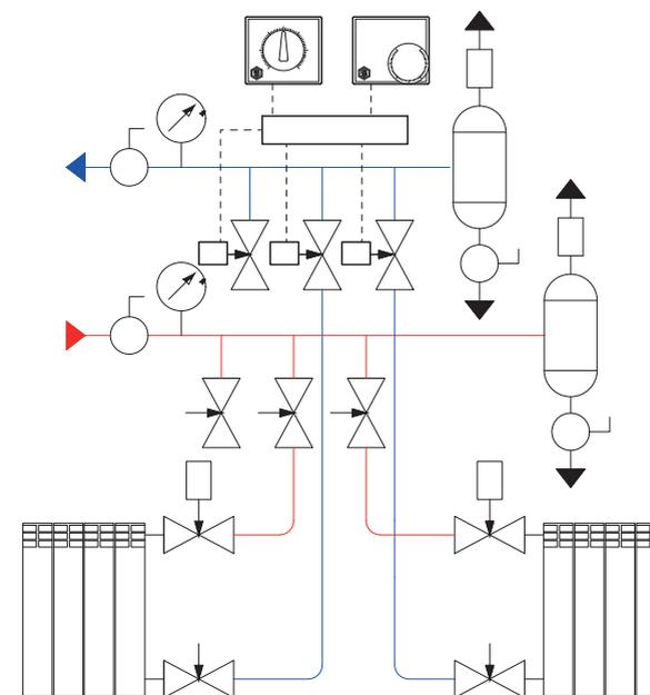
Система радиаторной разводки с коллекторной группой SMS 0912 и PE-Xb/Al/PE-Xb трубами
