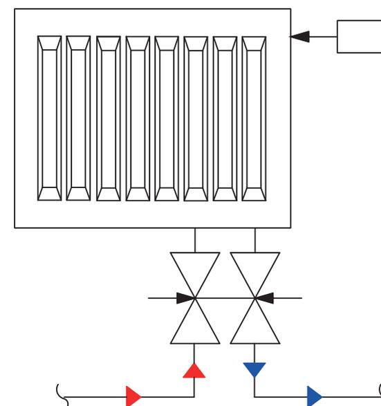
Обвязка радиатора с узлами нижнего подключения (H-образными, регулируемый байпас) полиэтиленовыми трубами PE-Xa/EVOH и аксиальными фитингами
