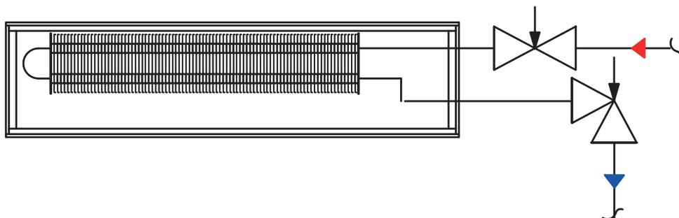
Обвязка внутривольного конвектора с запорно-балансировочными клапанами металлопластиковыми трубами PE-Xb/Al/PE-Xb и винтовыми фитингами
