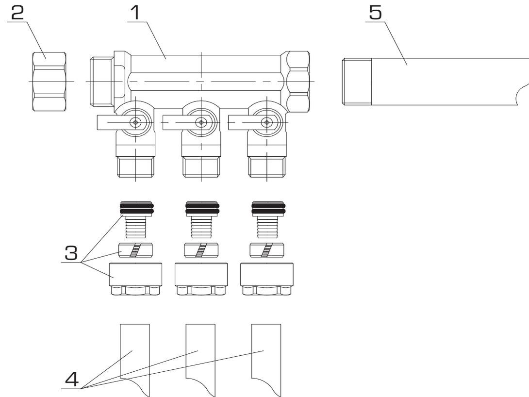
**Система водоснабжения с коллекторной группой SMB 6200 и PE-Xb/Al/PE-Xb трубами**
