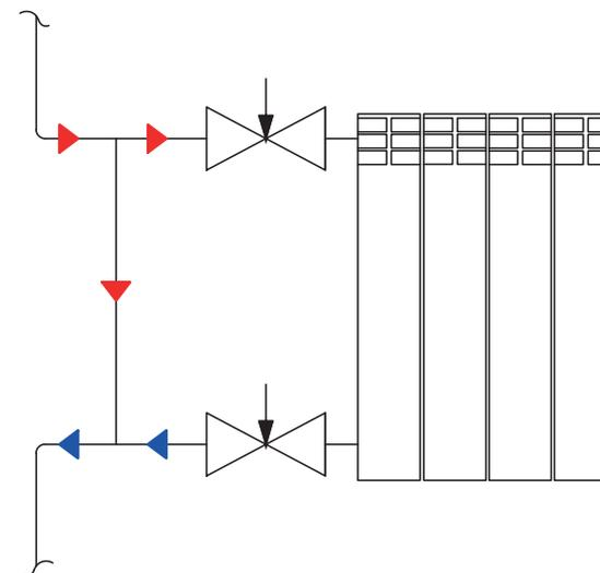
Обвязка радиатора с термостатическим клапаном (и головкой термостатической) металлополимерными трубами PE-Xb/Al/PE-Xb и пресс-фитингами
