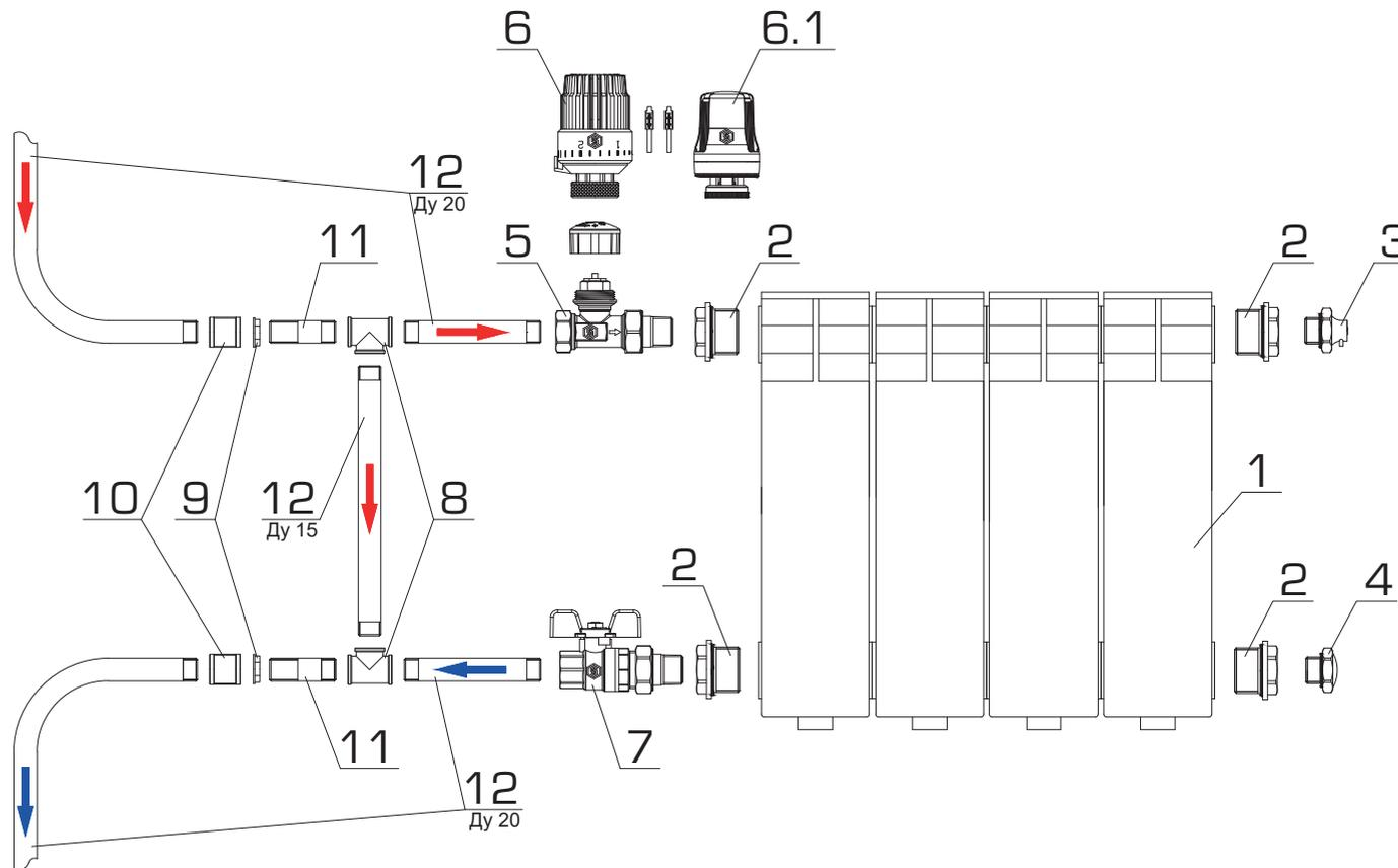
\* термостатическая головка должна находиться в горизонтальном положении относительно пола
