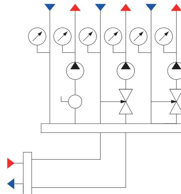
Гидро модули быстрого монтажа с вертикальным гидравлическим разделителем, коллектором распределительным с верхним расположением выходных патрубков и водогазопроводными трубами
