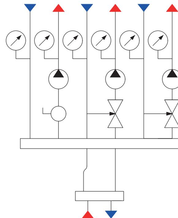
Гидро модули быстрого монтажа с горизонтальным гидравлическим разделителем, коллектором распределительным с верхним расположением выходных патрубков и водогазопроводными трубами
