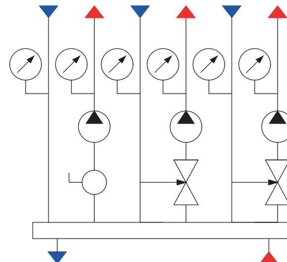
Гидро модули быстрого монтажа с коллектором распределительным (со встроенным гидравлическим разделителем, верхним расположением выходных патрубков) и водогазопроводными трубами
