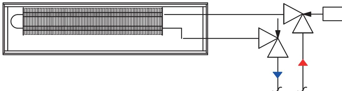
Обвязка внутривольного конвектора с запорно-балансировочными клапанами металлопластиковыми трубами PE-Xb/Al/PE-Xb и винтовыми фитингами
