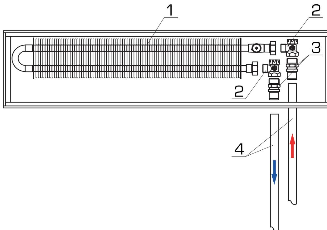
Обвязка внутривольного конвектора с запорно-балансировочными клапанами металлопластиковыми трубами PE-Xb/Al/PE-Xb и пресс-фитингами
