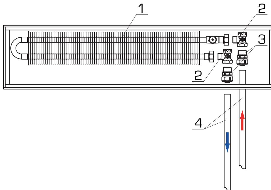
Обвязка внутривольного конвектора с запорно-балансировочными клапанами металлопластиковыми трубами PE-Xb/Al/PE-Xb и винтовыми фитингами
