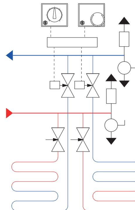
Система теплого пола с коллекторной группой SMS 0927 и PE-X трубами
