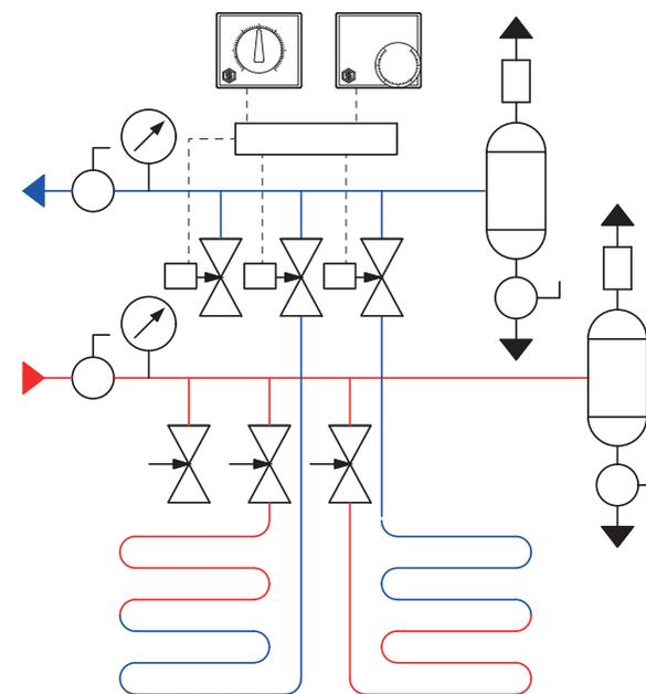
Система теплого пола с коллекторной группой SMS 0907 и PE-Xb/Al/PE-Xb трубами
