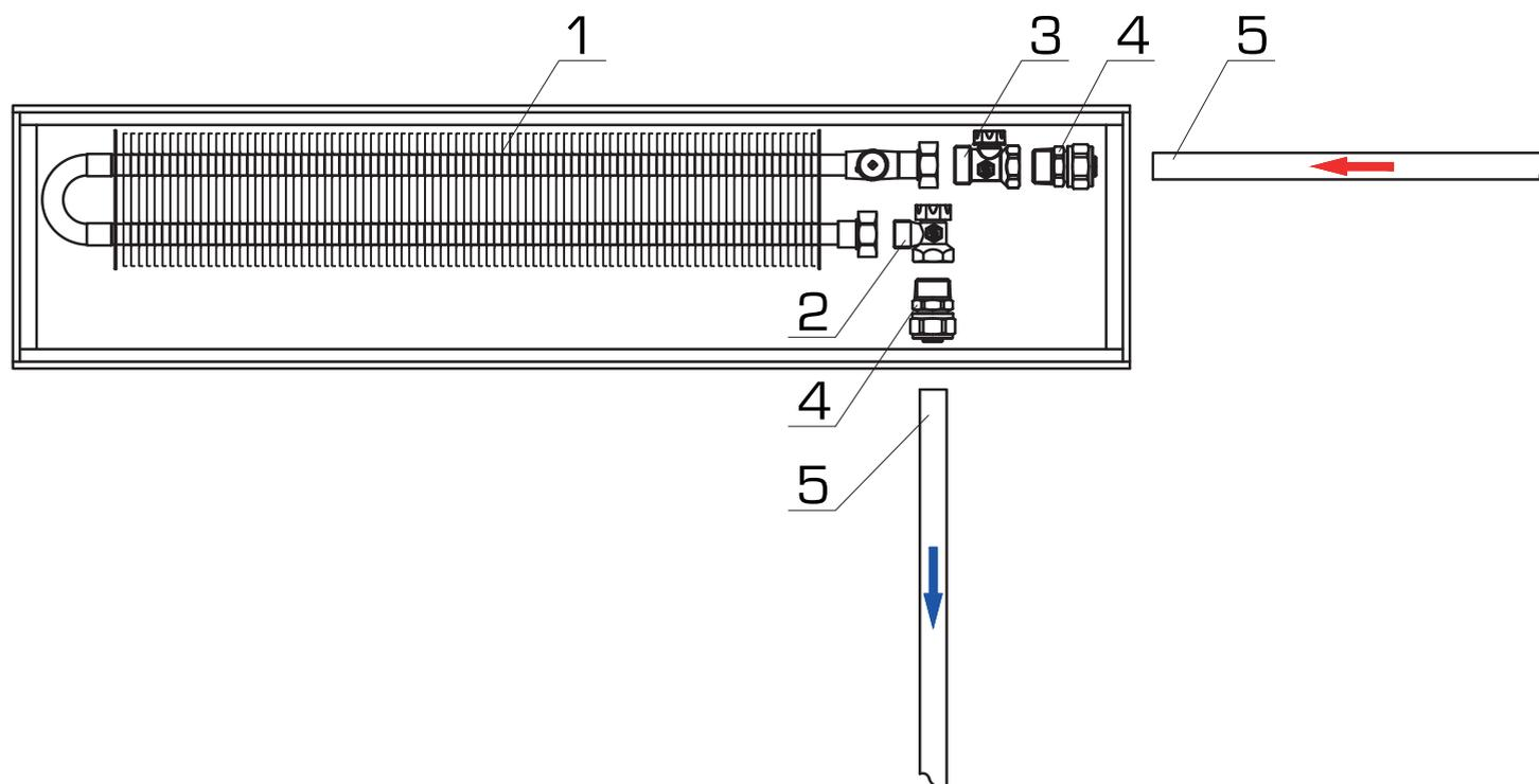
Обвязка внутривольного конвектора с запорно-балансировочными клапанами металлопластиковыми трубами PE-Xb/Al/PE-Xb и винтовыми фитингами
