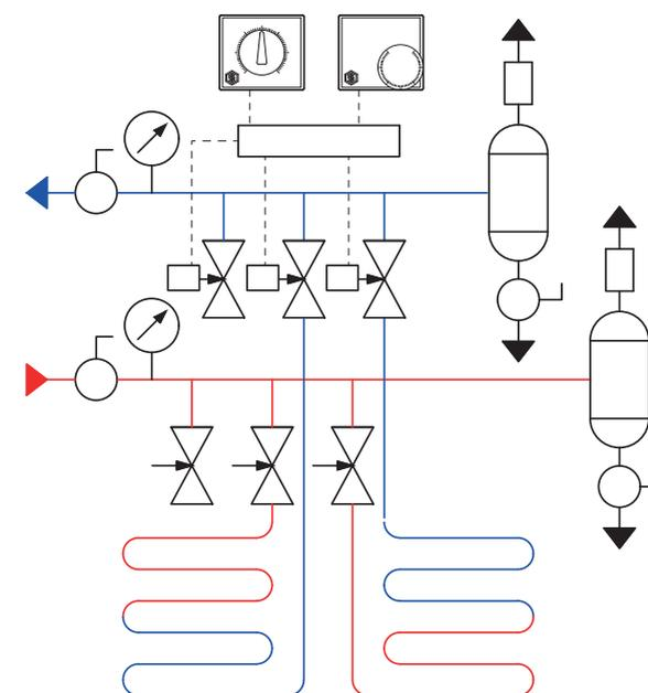
Система теплого пола с коллекторной группой SMS 0907 и PE-X трубами
