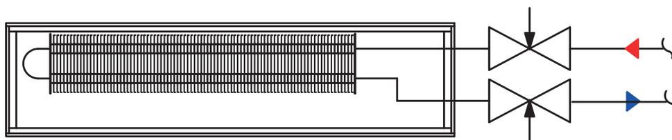
Обвязка внутривольного конвектора с запорно-балансировочными клапанами металлопластиковыми трубами PE-Xb/Al/PE-Xb и винтовыми фитингами
