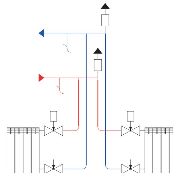
Система радиаторной разводки с коллекторной группой SMS 0923 и PE-Xb/Al/PE-Xb трубами
