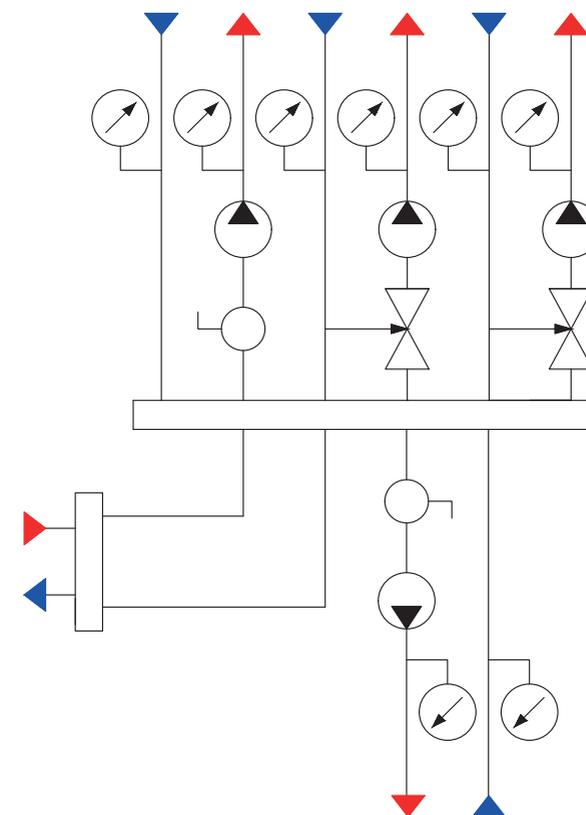
Гидро модули быстрого монтажа с вертикальным гидравлическим разделителем, коллектором распределительным универсальным и водогазопроводными трубами
