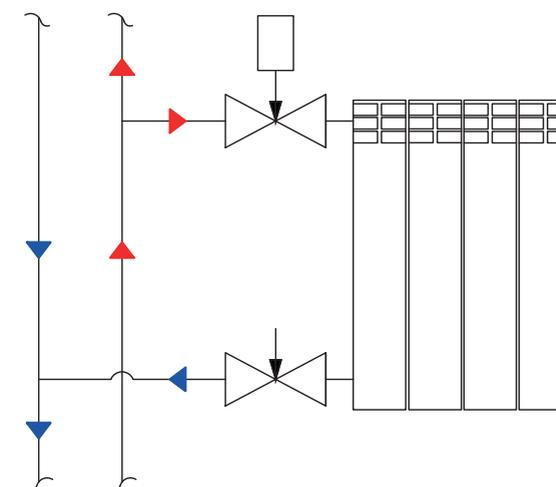
Обвязка радиатора с термостатическим клапаном (и головкой термостатической) металлополимерными трубами PE-Xb/Al/PE-Xb и пресс-фитингами
