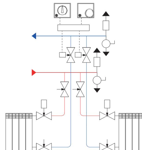
Система радиаторной разводки с коллекторной группой SMS 0932 и PE-Xb/Al/PE-Xb трубами
