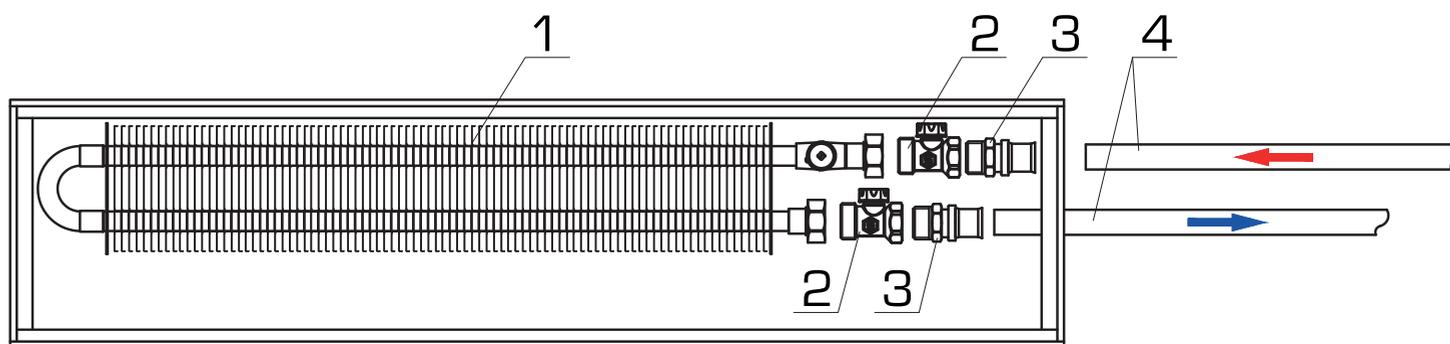
Обвязка внутривольного конвектора с запорно-балансировочными клапанами металлопластиковыми трубами PE-Xb/Al/PE-Xb и пресс-фитингами
