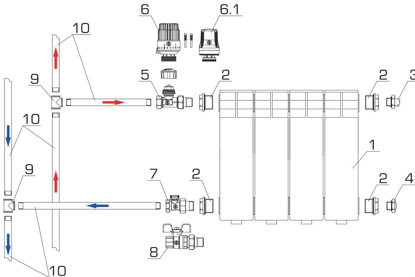
\* термостатическая головка должна находиться в горизонтальном положении относительно пола
