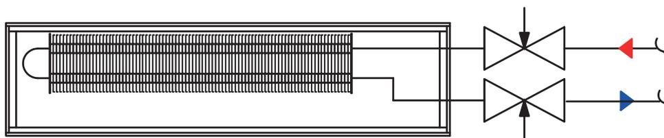
Обвязка внутриспольного конвектора с запорно-балансировочными клапанами полиэтиленовыми трубами PE-Xa/ PE-Xc/ Al/ PE-Xc и аксиальными фитингами
