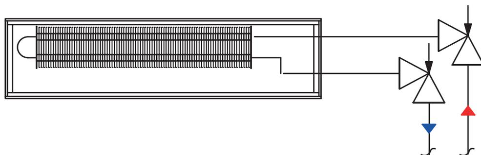
Обвязка внутривольного конвектора с запорно-балансировочными клапанами полиэтиленовыми трубами PE-Xa/ PE-Xc/ Al/ PE-Xc и аксиальными фитингами
