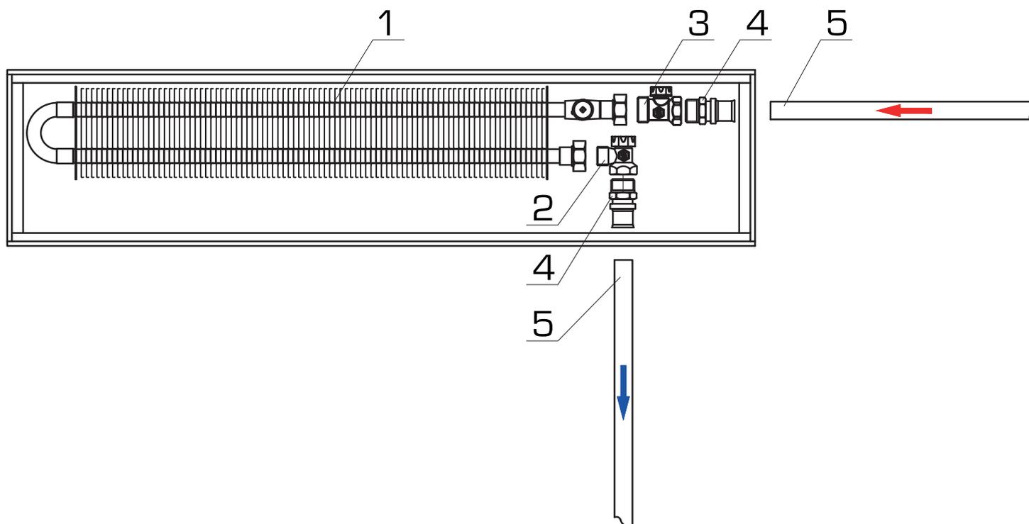
Обвязка внутривольного конвектора с запорно-балансировочными клапанами металлопластиковыми трубами PE-Xb/Al/PE-Xb и пресс-фитингами
