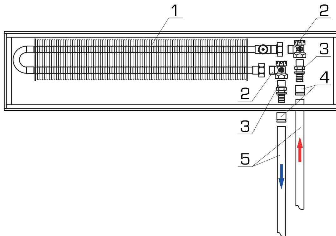
Обвязка внутривольного конвектора с запорно-балансировочными клапанами полиэтиленовыми трубами PE-Xa/ PE-Xc/ Al/PE-Xc и аксиальными фитингами
