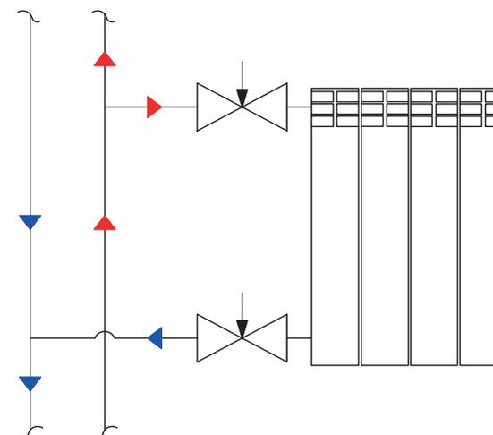
Обвязка радиатора с клапаном ручным регулировочным металлополимерными трубами PE-Xb/Al/PE-Xb и пресс-фитингами
