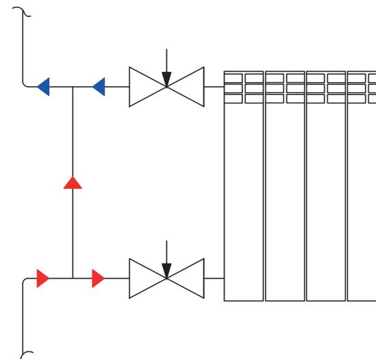
Обвязка радиатора с клапаном ручным регулировочным металлополимерными трубами PE-Xb/Al/PE-Xb и пресс-фитингами
