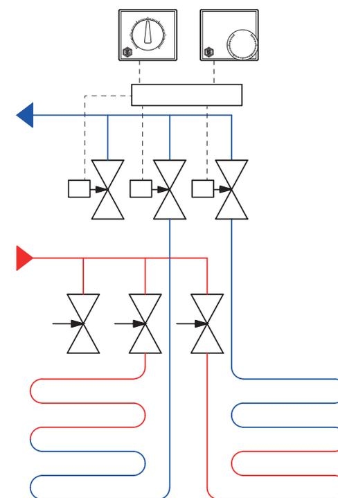
Система теплого пола с коллекторной группой SMS 0917 и PE-Xb/Al/PE-Xb трубами
