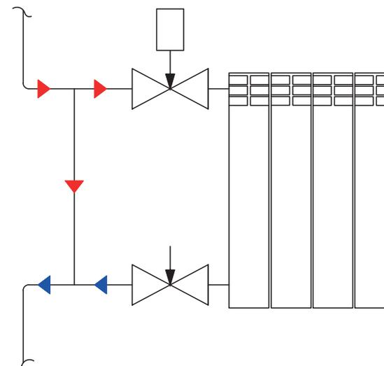
Обвязка радиатора с термостатическим клапаном (и головкой термостатической) металлополимерными трубами PE-Xb/Al/PE-Xb и винтовыми фитингами
