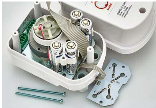
Фото 31. Контактная площадка снята, батарейки могут быть заменены
