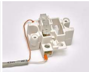
Фото 22. Подключение проводного выключателя
