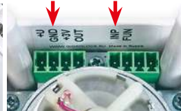
Фото 13. Клеммы подключения проводных датчиков — INP, GND
