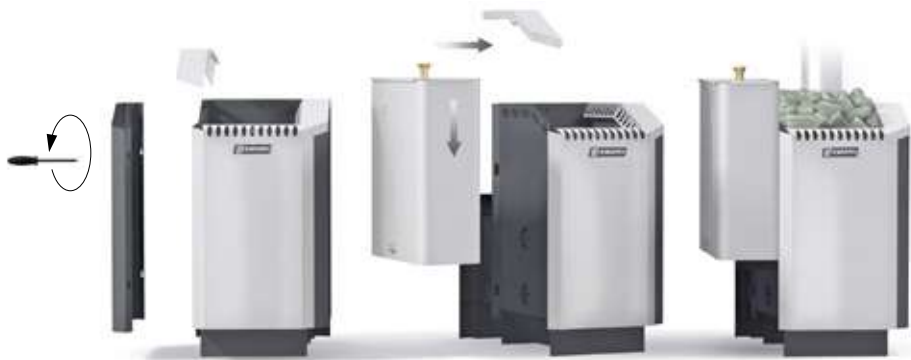
Рисунок-11. Схема установки навесного бака
