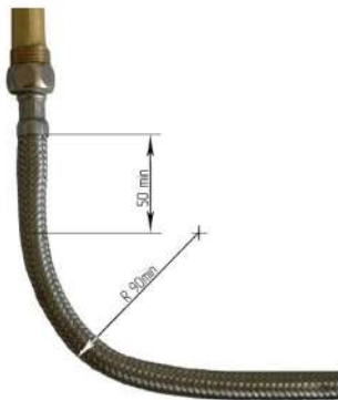
Рис. 4 Требования к монтажу гибких шлангов
