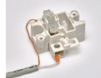
Фото 5. Подключение проводного выключателя
