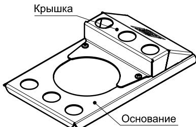
Рисунок - 2. Модуль закрытой каменки для печей в исполнении «Сетка»
