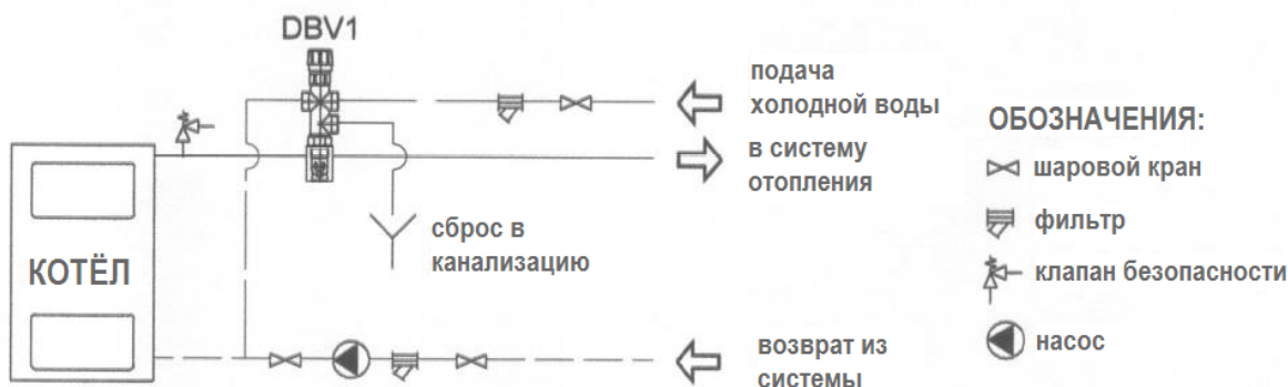
Рис.3 Схема системы с двухходовым клапаном безопасности DBV1.
