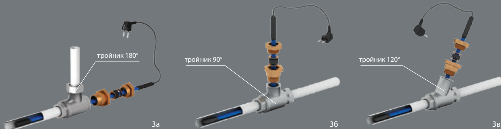
Рис.3. Схемы ввода нагревательной секции внутрь трубопровода: а - прямой ввод; б - ввод под углом 90°; в - ввод под углом 120°
