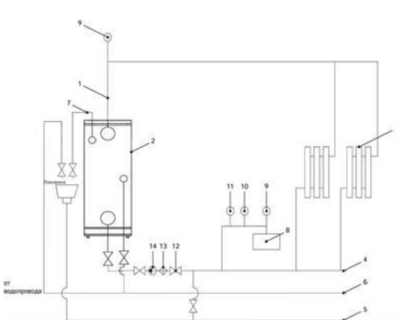
1 – главный стояк; 2 – котел; 3 – радиатор; 4 – трубопровод обратной воды; 5 – сливная магистраль; 6 – подпиточный водопровод; 7 – трубопровод горячей воды на бытовые нужды; 8 – мембранный расширительный бак; 9 – автоматический клапан выпуска воздуха; 10 – манометр; 11 – предохранительный клапан 0,15 МПа (1,5 кгс/см<sup>2</sup>); 12 – кран; 13 – фильтр; 14 – насос.
