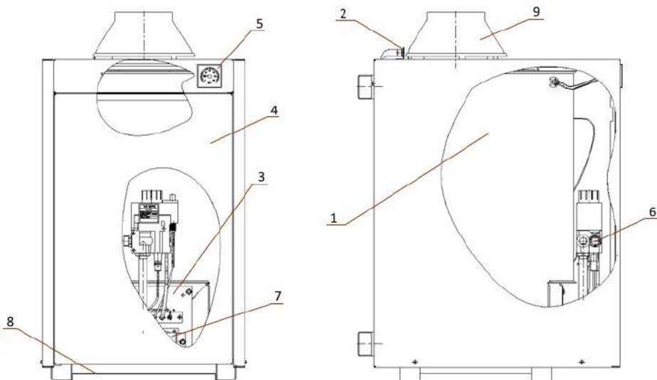
1 – теплообменник; 2 – датчик тяги; 3 – устройство газогорелочное; 4 – облицовка; 5 – термометр; 6 – подводка газовая; 7 – коллектор; 8– металлический экран; 9 – Антирефулер (стабилизатор тяги). **Рисунок не определяет конструкцию котла**
