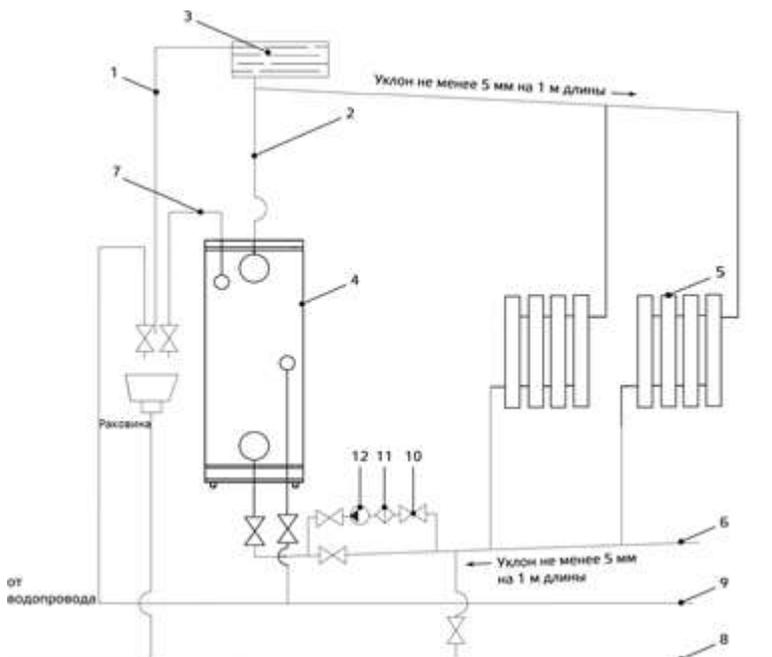
1 – сигнальная труба; 2 – главный стояк; 3 – расширительный бак; 4 – котел; 5 – радиатор; 6 – трубопровод обратной воды; 7 – трубопровод горячей воды; 8 – сливная магистраль; 9 – водопровод подпиточный; 10 – кран; 11 – фильтр; 12 – насос
