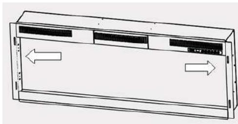
3. Если на боковых панелях камина нет отверстий, выкрутите винт на заднем нижнем фланце, наиболее удобном для крепления, и с помощью Г-образного кронштейна (входит в комплект) закрепите топку в проёме.
