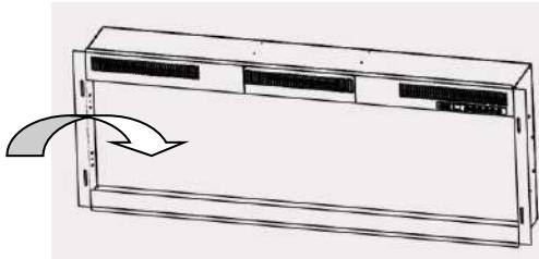
2. При установке на каминную полку/проём сначала проверьте, есть ли отверстия в боковых панелях в верхней части, как показано ниже. В этом случае совместите переднюю часть топки (без установленного переднего стекла и боковых зеркал) с передней стороной каминной полки, а затем используйте прилагаемые винты для установки топки. Винт совпадет с отверстием в каминной полке, зафиксируя его на месте.
