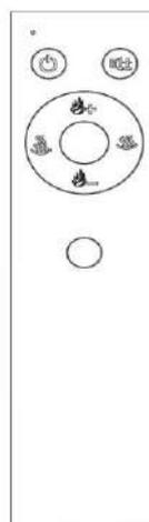
Управлять электрообогревателем можно с панели управления на приборе или с помощью пульта дистанционного управления. В пульт необходимо вставить батарейки, соблюдая при этом полярность.
