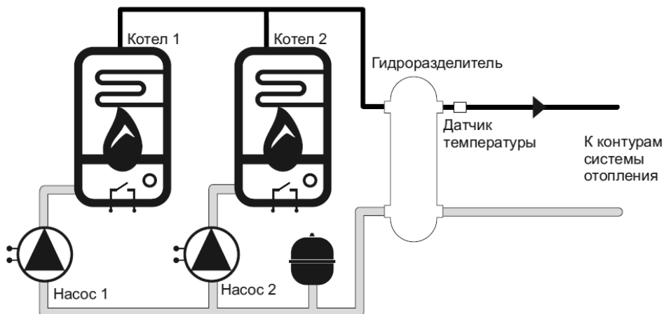
Рисунок 1 – Функциональная схема системы отопления
