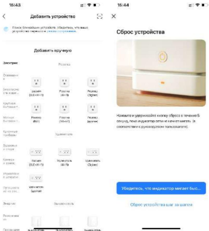
9. Проверьте состояние светового индикатора на устройстве и нажмите кнопку «Быстро мигает» на экране мобильного приложения соответствующую скорости мигания индикатора. После обнаружения устройства мобильное приложение перейдет к выполнению следующего шага.
