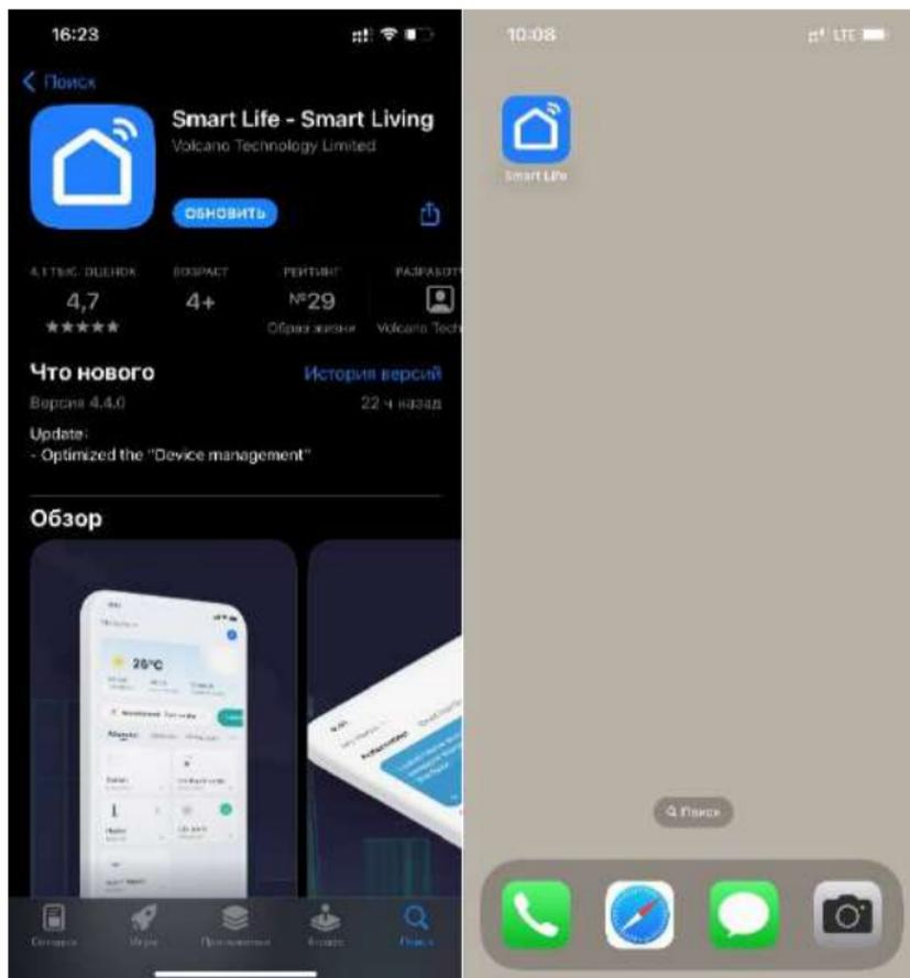
3. Для подключения блока управления Wi-Fi на главной странице приложения «Smart Life» нажмите знак «+». При нажатии на устройстве кнопки установки и сброса настроек более 5 секунд все ранее записанные параметры будут сброшены и устройство перейдет в режим подключения.
