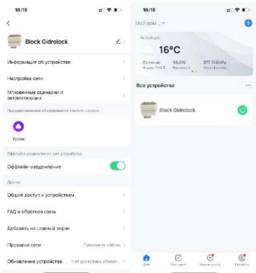
15. На вкладке устройства отображается состояние подключенных кранов. Здесь же можно управлять состоянием крана: открывать и закрывать его. Также на главном экране отображается запись о последнем событии.
