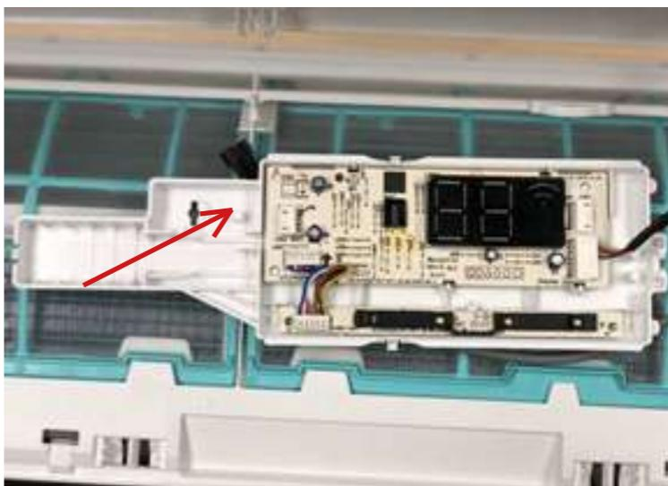
6. На фотографии представлен вид снятого дисплея. Стрелка показывает на разъем для кабеля подключения Wi-Fi модуля.
