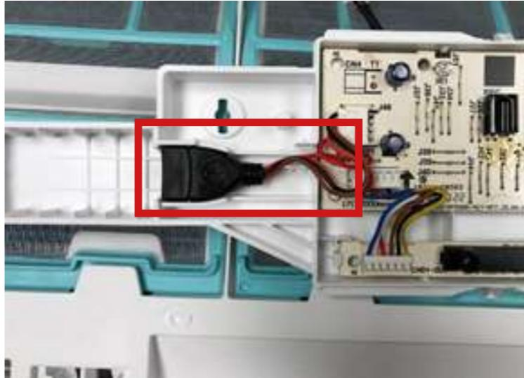
В современных моделях данный кабель уже установлен и подключен на заводе, как на этом фото.
